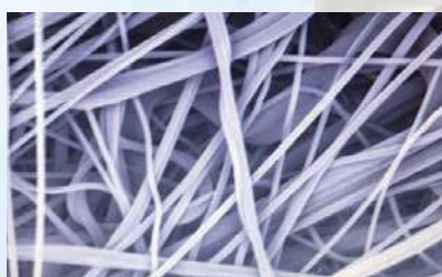
在電子顯微鏡下，原好口罩纖維的狀況
