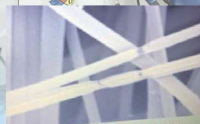
受損的口罩纖維，呈斷裂的情況
